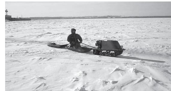
Рис. 1 Буксировщик «РЕКС» в рабочем состоянии
