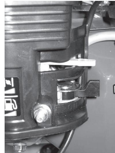
Рис.13 Управление топливным краном
