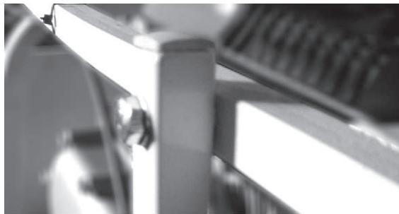
Рис. 10. Положение фиксирующего болта при транспортировке
